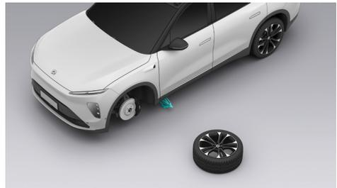
7. Entfernen Sie die Radschrauben und wechseln Sie das Rad. Achten Sie beim Anbringen des Ersatzrads darauf, dass sich die Radschrauben über den Montagelöchern befinden und die Metallfläche der Felge ordnungsgemäßen Kontakt mit der Montageoberfläche aufweist.
