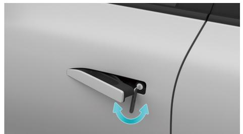
4. Um das Fahrzeug zu verriegeln, können Sie den mechanischen Schlüssel verwenden, um die Nut im Schlüsselloch an der Seite der Tür in eine vertikale Position zu drehen. Sobald die Tür geschlossen ist, wird sie verriegelt.
