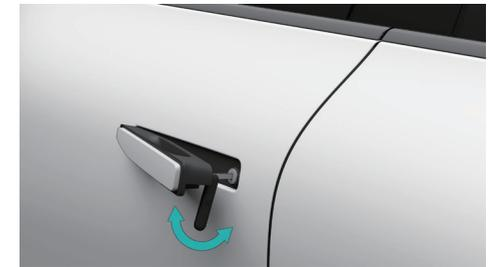
4. Um die Fahrertür zu verriegeln, drücken Sie ebenfalls auf den vorderen Bereich des Außengriffs und drehen den Notschlüssel gegen den Uhrzeigersinn, um zuerst zu entriegeln, und dann im Uhrzeigersinn, um zu verriegeln.
