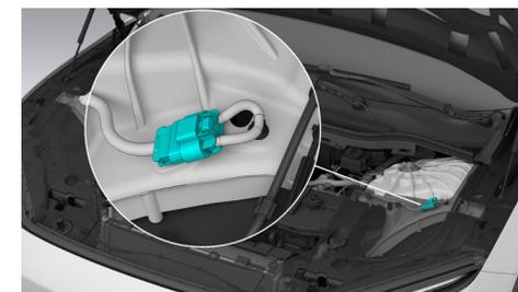
1. Entfernen Sie das Kabel, das mit dem Minuspol der 12-V-Batterie verbunden ist. Umwickeln Sie es mit Isolierband, um eine versehentliche Berührung zu vermeiden.
